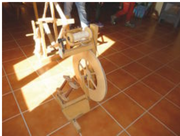
Aparello para facer as 'canillas' que se usarán no tear (A. de VV. O Santiaguíño). [Foto EDR]
